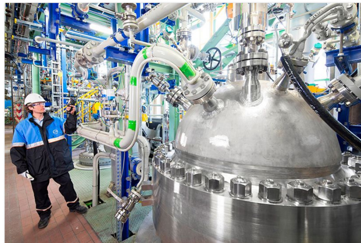
Kohlendioxid als neuer Rohstoff: In dieser Produktionsanlage in Dormagen baut Covestro 20 Prozent CO 2 in eine wichtige Schaumstoff-Komponente ein.
