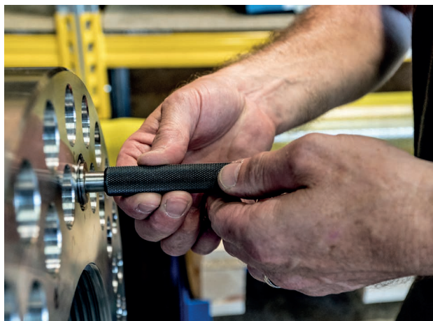
À la demande de sociétés japonaises, l'entreprise suisse Nord-Lock AG a développé pour ITER des tendeurs à boulons multiples «Superbolt». Uniques, ils sont capables de résister aux charges opérationnelles et cycliques requises et de fonctionner à des températures avoisinant les -269\text{ }^{\circ}\text{C} , proches du zéro absolu. Photo: Swiss IKC Nord-Lock
