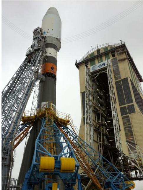
En parallèle, elles ont procédé aux adaptations européennes nécessaires, comme la construction d'un portique pour l'intégration finale verticale ou l'ajout d'un kit de sauvegarde. Les deux versions du lanceur Soyouz ST, Soyouz 2.1a et 2.1b, pourront être exploitées depuis le CSG. En outre, tant le pas de tir que la fusée Soyouz répondent aux exigences des vols habités et une telle utilisation serait donc possible.
