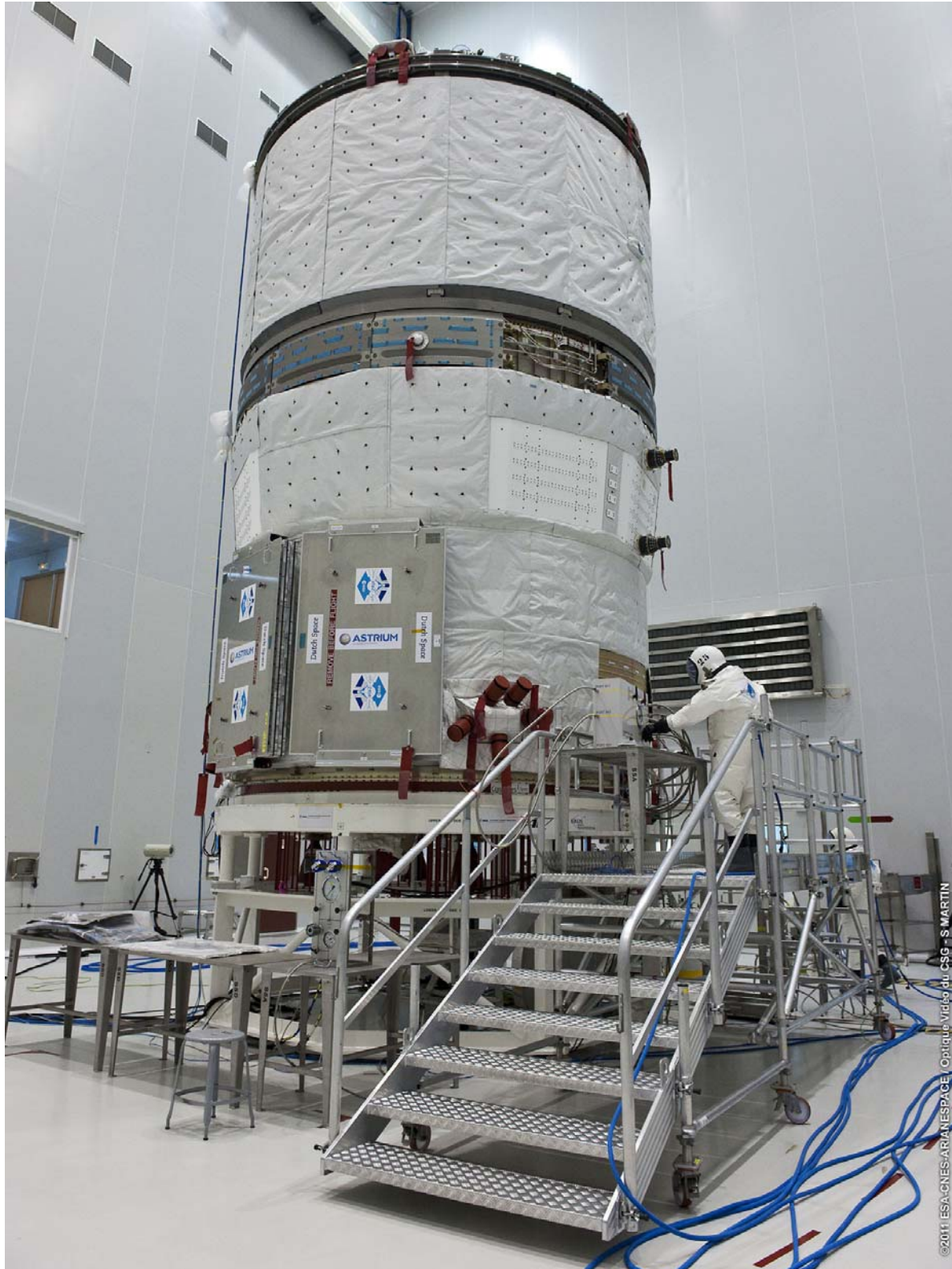
Versement de carburant dans un réservoir du véhicule de transport spatial ATV-2 Johannes Kepler au Port Spatial Européen à Kourou (Guyane française) Image : Ariespace
